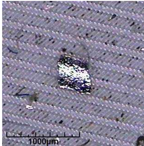
Segunda Maior Partícula Metálica Encontrada Second largest metal particle length 675 µm x 501 µm
