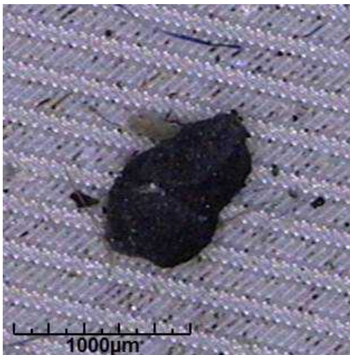
Primeira Maior Partícula Não Metálica Encontrada Largest nonmetallic particle 1008 µm x 692 µm
