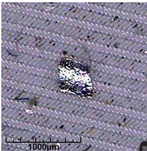
Segunda Maior Partícula Metálica Encontrada Second largest metal particle length 675 µm x 501 µm
