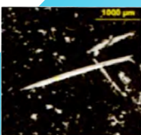
Partículas de um processo de fixação por parafuso
