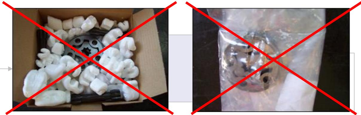
As peças devem ser retiradas do processo de acordo com a forma pré-definida e deve ser embalado de forma limpa: Saco plástico individual, carga pequena, sem acúmulo de peças.
