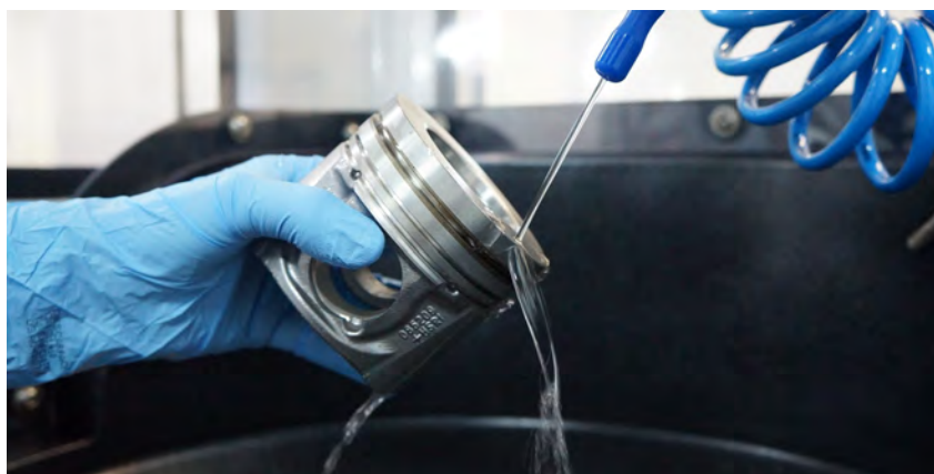
Extração de partículas com cabine de extração
