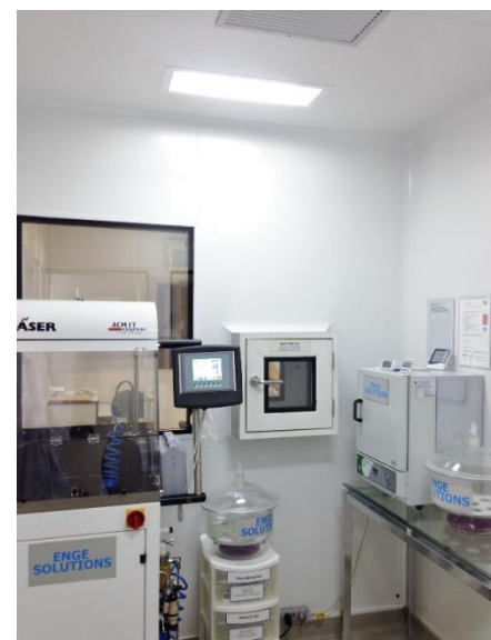
Laboratório cleanliness com sala ISO classe 7
