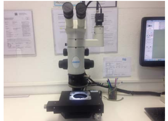
Microscópio para contagem automática de partículas JOMESA GmbH
